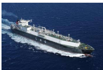
薄膜型LNG运输船
